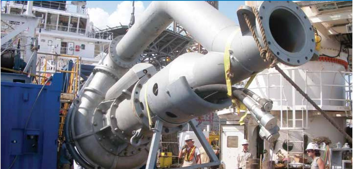
La Toyo sumergible serie DP y su 'prima' de accionamiento hidráulico, la serie TO, se diseñaron específicamente para recoger y transportar materiales abrasivos con la menor cantidad de agua.
