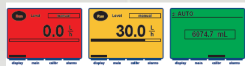
Alarma Mantenimiento Calibración
